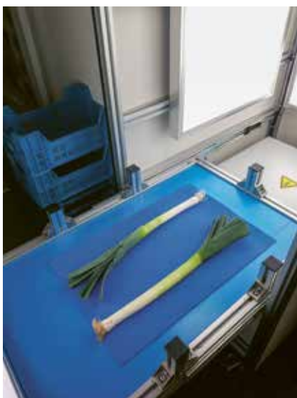
Figuur 1: Visiesysteem voor de bepaling van tripsaantasting van prei
